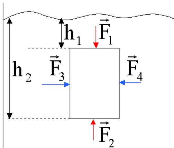
Aus der Abbildung folgt, dass sich die Seitenkräfte aufheben, also
