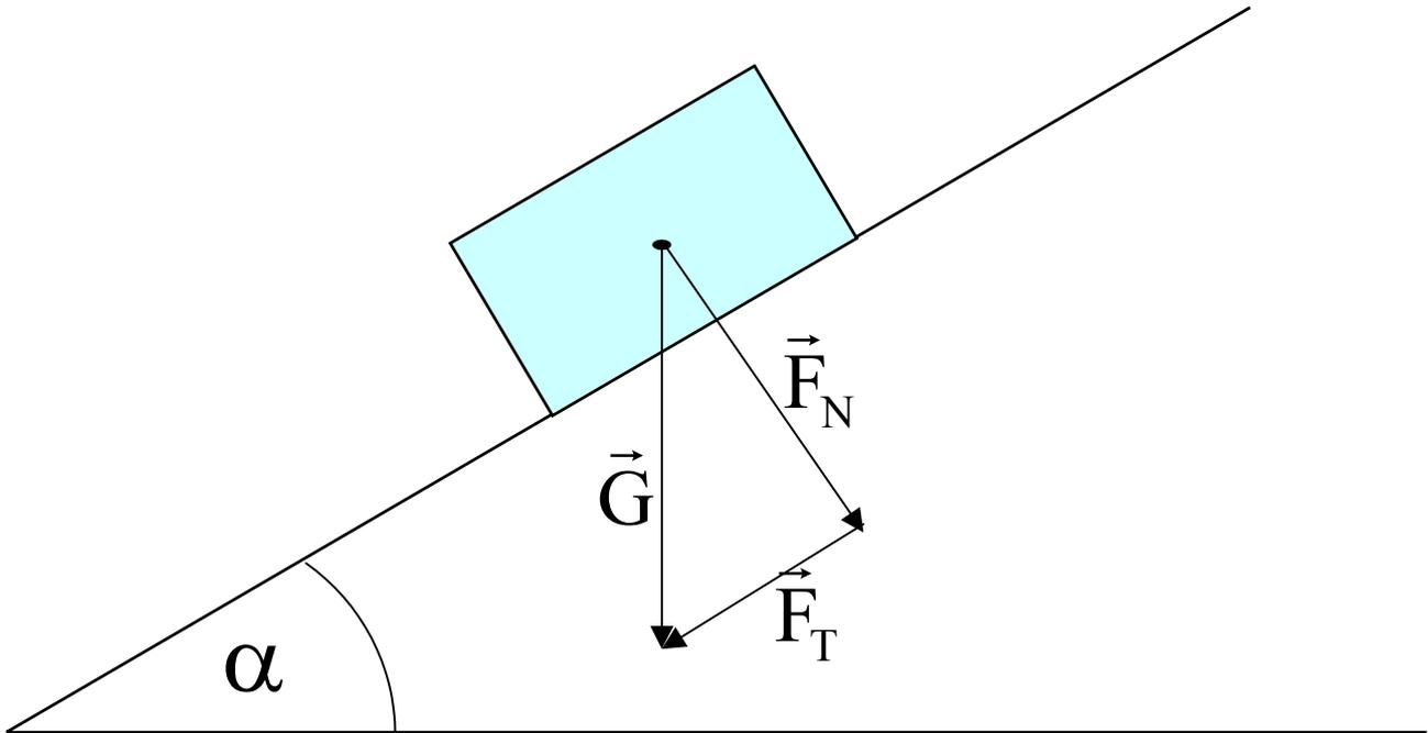
Im Experiment wird der Neigungswinkel solange vergrößert, bis die Hangabtriebskraft (Tangentialkraft) gleich der maximalen Haftreibungskraft ist. Es gelten folgende Beziehungen:
