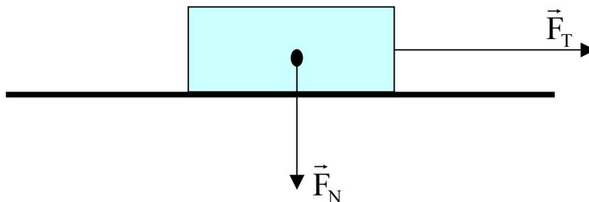
Das Coulombsche Gesetz beschreibt den Zusammenhang zwischen der Schwellkraft  $\vec{F}_{HS}$ , der Normalkraft  $\vec{F}_N$  und dem Haftreibungskoeffizienten  $\mu_H$  sowie der angreifenden Tangentialkraft  $\vec{F}_T$ :
