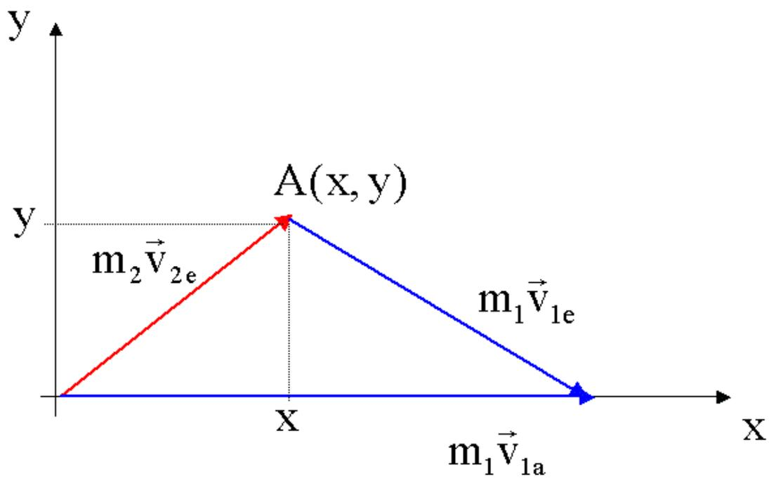
Gesucht ist die Menge aller Punkte  $A(x,y)$  bei gegebenem Impuls  $\vec{p}_{1a}$  der Kugel  $m_1$ .
