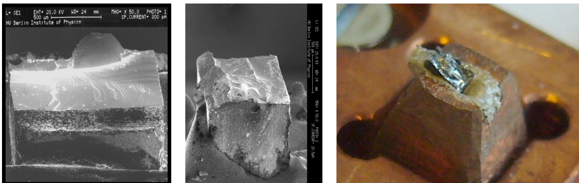
Abbildung 6.4: Die linke Aufnahme mit einem Rasterelektronenmikroskop zeigt eine Spaltung entlang der Sollbruchstelle. Diese ist als 100\ \mu\text{m} tiefer Graben im Vordergrund zu erkennen. Das mittlere Bild zeigt die fragmentierte Oberfläche nach einer Spaltung im Vakuum. Rechts ist die Photographie eines bei der Spaltung zersplitterten Kristalls zu erkennen.
