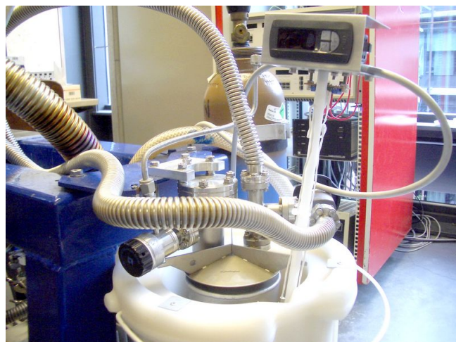
Abbildung 4.3: Temperaturcontroller der Nachfüllanlage im Isolierbehälter für flüssigen Stickstoff.
