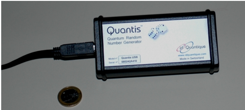
Abbildung: Zufallsgenerator als USB-Modul. [uni-erlangen]
