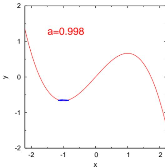
$a < 1$ : instabiles Gleichgewicht (oszillierend. Zustand)
